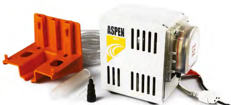
Die Schlauchpumpe der Baureihe MK4 arbeitet mit zwei Wasserstandssensoren. Wenn der untere Sensor mit Wasser in Berührung kommt, erkennt die Einheit aufgrund der Wärmeleitfähigkeit einen Temperaturunterschied zum zweiten Sensor – und die Pumpe wird eingeschaltet.
