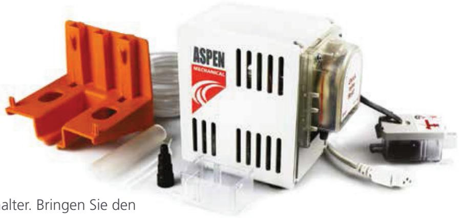
Schlauchpumpentechnik mit Schwimmerschalter. Bringen Sie den Behälter (Schwimmerschalter) einfach in der Kondenswasserwanne an, oder befestigen Sie ihn am Kondensatwannenanschluss (je nach gewähltem Behälter). Alarm-Option erhältlich.
